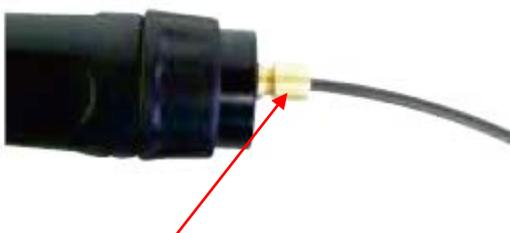
(6) Плотно наденьте направляющий канал на штуцер горелки и затяните стопорную гайку.
