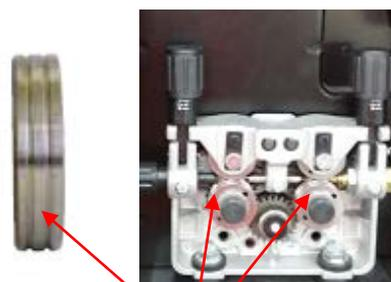
(10) Установите приводной ролик с криволинейным скосом двух кромок в форме буквы U подходящего размера, соответствующего диаметру используемой проволоки.
