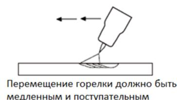
приблизительно  $75^\circ$  и плавно и равномерно двигаться вдоль сварного шва, сплавляя материалы вместе.
