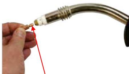
(14) Снимите газовое сопло и контактный наконечник с горелки MIG.
