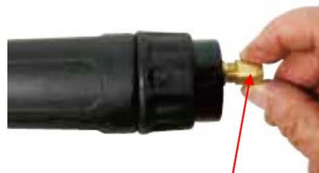
(6) Установите стопорную гайку направляющего канала и закрутите ее лишь наполовину.
