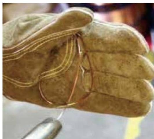
(9) Масса и скорость вращения катушки с проволокой создают момент инерции, способный привести к тому, что катушка будет продолжать вращение в то время, как проволока будет выходить за край катушки и запутается. В этом случае следует увеличить давление на натяжную пружину, расположенную внутри узла держателя катушки, при помощи регулировочного натяжителя.
