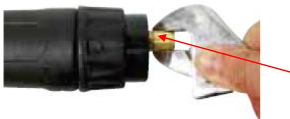
(9) До конца закрутите стопорную гайку и плотно затяните её.
