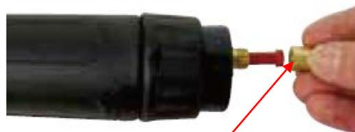
(2) Снимите стопорную гайку, удерживающую направляющий канал
