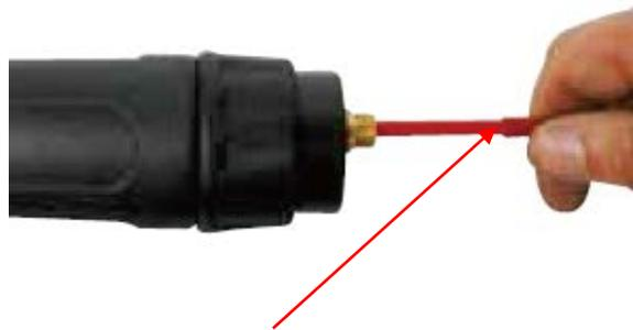
(3) Осторожно удалите направляющий канал с кабельного узла горелки
