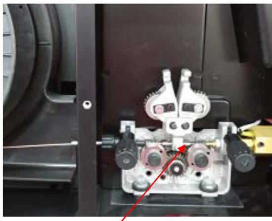
(5) Протяните проволоку через приводной ролик и в выходную направляющую трубку механизма подачи проволоки.
