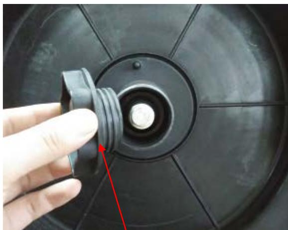
(1) Отверните прижимную гайку крепления катушки.
