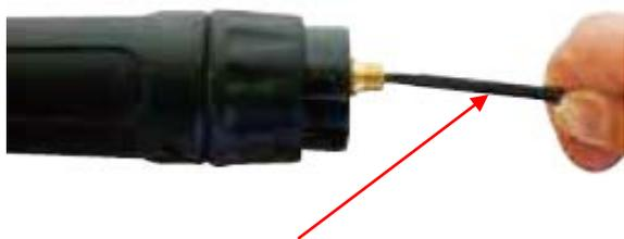
(5) Медленно и аккуратно, короткими движениями, продвигайте направляющий канал по кабельному узлу к концу горелки и наружу. Избегайте перекручивания.
