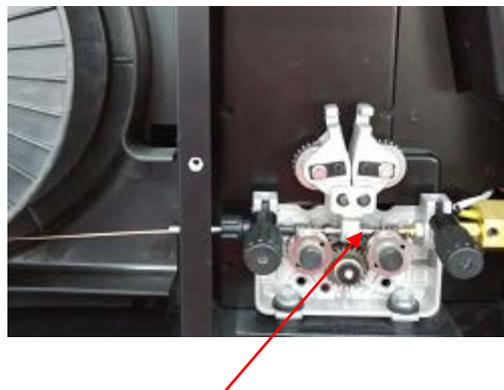
(12) Протяните проволоку через приводной ролик в выпускную направляющую трубку таким образом, чтобы проволока вышла на расстояние примерно 150 мм.
