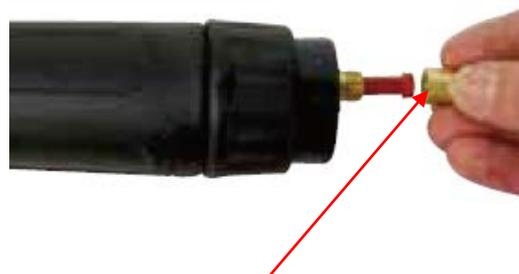
(2) Снимите стопорную гайку направляющего канала
