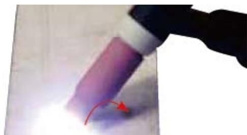
(18) Поверните газовый колпачек в обратном направлении для подъема вольфрамового электрода от заготовки и возбуждения дуги.
