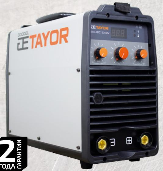
**Универсальность подключения** – аппарат способен работать от однофазной сети 220 В и трехфазной 380 В, а также устойчив к перепадам напряжения от 140 до 560 В, что позволяет подключаться практически к любой сети.
